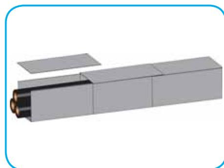
Posati i cavi di energia, nell'ultima fase verranno installati i coperchi, sempre con la sovrapposizione di circa 200 mm e successivamente accoppiati con il canale sottostante per mezzo dei ganci metallici a molla, ad un interasse di circa 300 mm.
